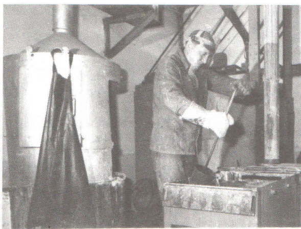
Tavicí pec kadmia a jeho odlévání do forem.
